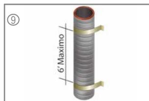
9.- Los conductos instalados verticalmente tienen que ser estabilizados por cinchos a un máximo de seis pies entre soportes a través del centro.
