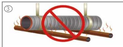
3.- No lo instale cerca de superficies calientes (calderas, tubos de vapor, calentadores, balastos, etc).
