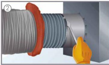
2.- Jale la cubierta metálica y el aislamiento, dejando al descubierto el núcleo. Deslice al menos 1 pulg. (254 mm) de núcleo sobre el collar. Cubra el núcleo con al menos dos vueltas de cinta para ducto. También puede usarse una abrazadera.
