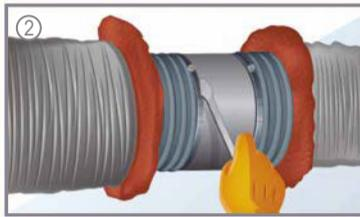
2.- Cubra los núcleos con al menos dos vueltas de cinta para ducto. Asegure con dos abrazaderas.
