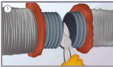
1.- Determine la longitud deseada. Corte completamente alrededor y a través del ducto con tijera o navaja. Corte el alambre con pinzas o tijeras de alambre.
