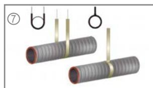
7.- El material que soporta al tubo no debe ser menos a 1.5 pulg. (38 mm) de ancho y no debe afectar el diámetro del ducto.
