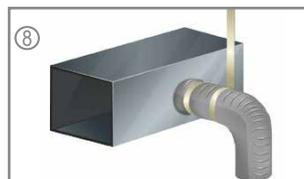
8.- Soporte el ducto entre una conexión de metal y un doblez, permitiendo al ducto extenderse derecho unas cuantas pulgadas antes de hacer el doblez.
