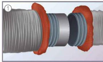
1.- Jale la cubierta metálica y el aislamiento, dejando al descubierto el núcleo. Una ambos núcleos con una manga de metal estándar de 4 pulg. (100 mm) de largo.
