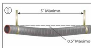
6.- El ducto flexible debe colgarse a un máximo de 5 pies (1.5 mts) entre soportes y con una pendiente máxima de 1/2 pulg. (12.5 mm) por pie lineal. La conexión a un conducto rígido se considerara como un soporte.
