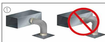
1.- Instale el ducto completamente extendido. No lo instale en su forma comprimida.
