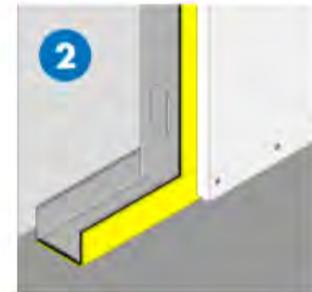
Es un producto bicapa formado por una membrana autoadhesiva de alta densidad es un polietileno químicamente reticulado termo soldado al interior.
