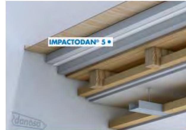
**PAVIMENTO FLOTANTE TERMOACÚSTICO**
