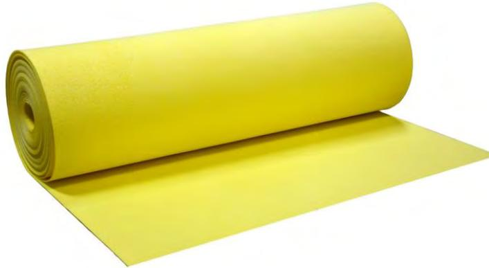
Membrana flexible de polietileno químicamente reticulado de celda cerrada que proporciona al producto una estructura interna elástica. Barrera de vapor, Acústicamente funciona como AMORTIGUADOR aplicando un sistema de masa-resorte-masa.
