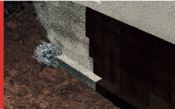
Recubrimiento compuesto de betún y solvente de rápida evaporación. Se utiliza para impermeabilizar muros de cimentación, zapatas, muros de contención, muros de ala, estribos y alcantarillas.
