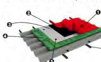
1- Membrana ampliada con fuego. 2- Imprimador. 3- Panel Substrato bajo.
