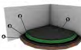
1- Firme de concreto. 2- TERMOFOAM® 3- Barrera de Vapor. 4- Cama de grava o plantilla de concreto. 5-Terreno compactado.
