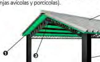
1- TERMOFOAM® 2- Lámina galvanizada. 3- Viga al centro.
