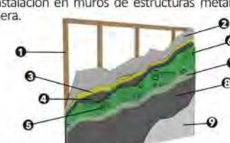
1-Bastidor metálico o de madera. 2- Tablero de yeso. 3- Impermeabilizante.
