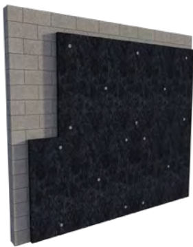
Sistema forrado para muros de mampostería
